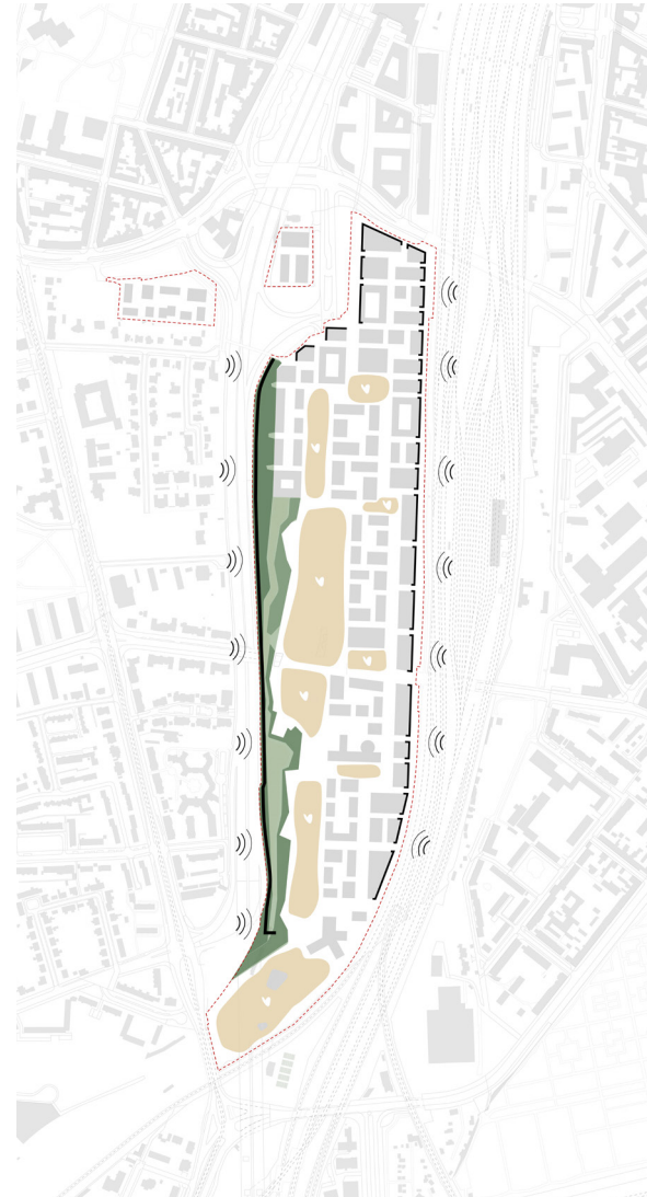
Wall-Struktur und dichte Bebauung zur Bahn hin wird zur Schallschutzwand
